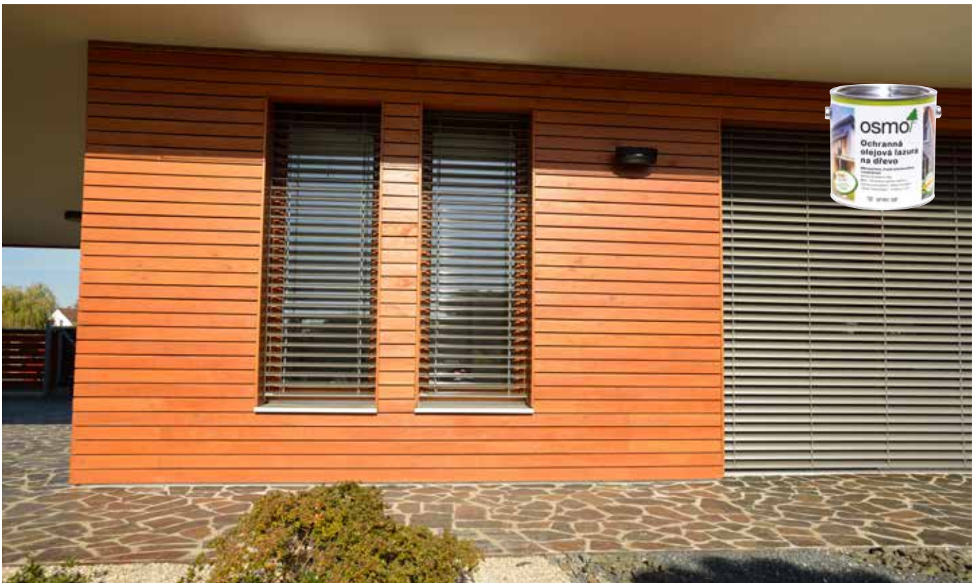
Fasáda REAL FACADE, Sibiřský modřín, profil Raute 20 x 93 mm, povrchová úprava OSMO Ochranná olejová lazura č. 728 cedr
